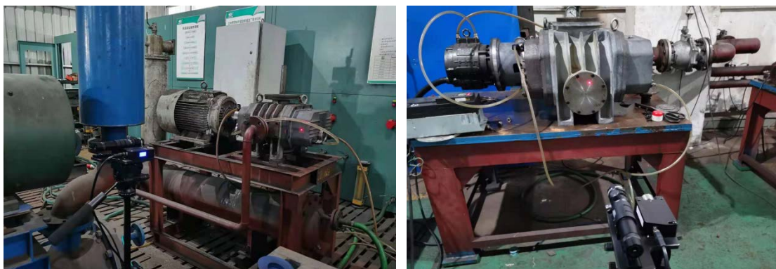
图 3：挚感方案应用在‘金川集团’泵机振动测试上
